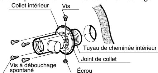
6. Continuer à tourner le tuyau de cheminée extérieur avec les brides intérieure et extérieure fermement ajustées contre les murs intérieur et extérieur.
