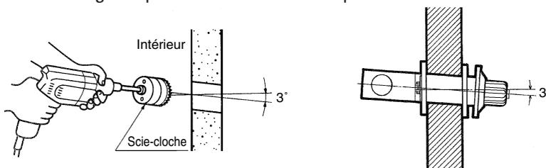
5. Installer le collet intérieur et le joint de collet au tuyau de cheminée intérieur, puis insérer ce dernier de l'intérieur à travers la découpe. S'assurer que la flèche du collet intérieur pointe vers le haut et fixer la bande de fixation via les deux trous de la bande d'arrêt avec une vis et un écrou. Fixer le tuyau de cheminée intérieur au mur à l'aide des quatre vis fournies dans l'emballage.
