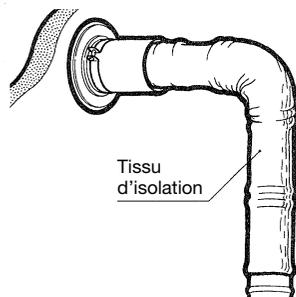
9. Retirer la vis de l'orifice d'évacuation de l'appareil. Insérer le tuyau d'évacuation flexible dans l'orifice d'évacuation, et fixez-les ensemble à l'aide de la vis.
