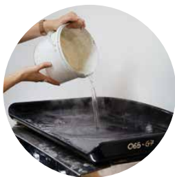
Contrôle de l'émail (résistance aux chocs mécaniques et aux chocs thermiques)
